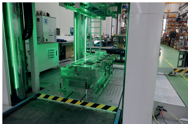
Bild 1. Die großen Werkzeuge lassen sich komplett aus der Presse herausfahren. So kann sie einfach, schnell und sicher per Kran beladen werden. Der Zustand der Maschine wird über die Beleuchtung an den Säulen signalisiert
